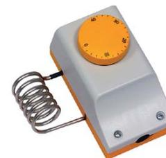
Комнатный термостат KTR-40 предназначен для контроля температуры воздуха в помещении, а также для управления системами вентиляции, кондиционирования и отопления. Капилляр, наполненный инертным газом, имеет спиралевидную форму и расположен вне корпуса термостата, что позволяет более быстро и точно реагировать на изменение температуры в помещении.
