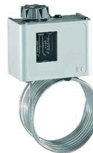
Капиллярный термостат КР предназначен для контроля температуры воздуха за теплообменниками с целью защиты их от замерзания. Для защиты водяного нагревателя от замерзания капилляр крепится с помощью монтажных скоб на поверхность теплообменника со стороны выхода воздуха. Для защиты фреонового испарителя капиллярную трубку наматывают на патрубков отвода хладагента.
